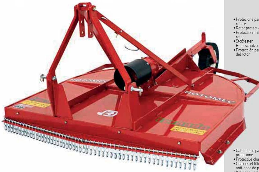
**E** Tornado es un cortacésped rotatorio de eje vertical con rotor único, apto para el uso en condiciones difíciles de trabajo, cuando la hierba es alta, no está cuidada o hay maleza y arbustos de dimensiones bastante grandes. También es adecuado para cortar tallos de maíz, paja, plantas de algodón, y para el mantenimiento periódico de los barbechos.
