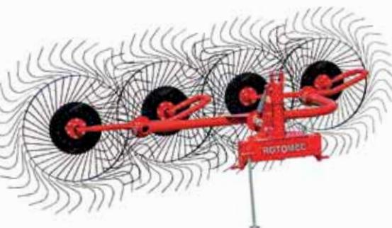
kompakter und gleichförmiger Ballen geformt werden kann. Die Zinken sind für einen sanften und sauberen Kontakt mit dem Futter aus Federstahl. Die schmierbaren Radnaben an den Rotomec Sternspinn-Rechwendern sind aus Stanzstahl und enthalten Kegelrollenlager, die eine besonders hohe Lebensdauer der Radnabe garantieren.
