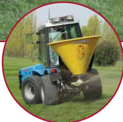
**I** Lo spandiconcime pendolare Turbo-Hop è una macchina estremamente versatile ed accurata, ideale per spargere non soltanto prodotti granulari o in polvere, ma anche per distribuire prodotti con un tasso di umidità fino al 30%.
