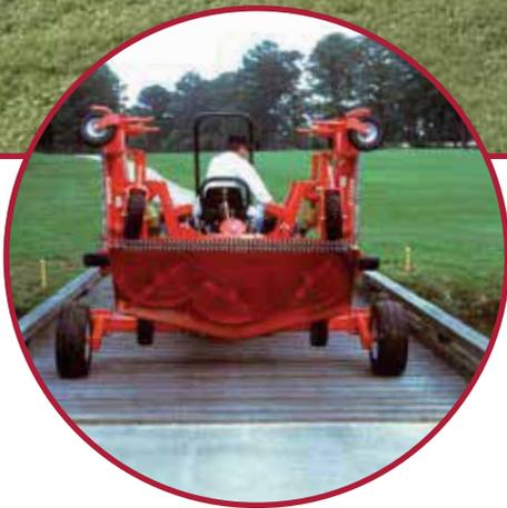
**I** Il rasaerba combinato Flex consiste in un telaio-carrello collegato meccanicamente ed idraulicamente a tre rasaerba ad asse verticale della serie Cyclone C50, forniti di scarico posteriore. Ciascun rasaerba lavora in maniera completamente indipendente dalle altre unità grazie ad un doppio attacco oscillante che collega il telaio ai rasaerba e che consente a questi di seguire le diverse ondulazioni del terreno.
