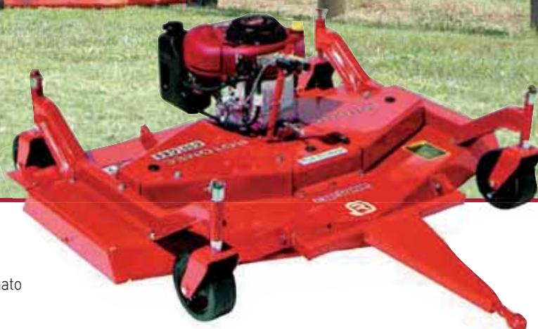
**I** Il C30-CE5 è un rasaerba trainato o spinto a tre giranti con scarico dell'erba posteriore, azionato da un motore a scoppio e quindi destinato a trattorini sprovvisti di presa di forza e ai quadricicli ATV. Il motore è un Briggs & Stratton da 10,5 HP dotato di frizione centrifuga con dispositivo d'arresto per la sicurezza. L'altezza di taglio varia da un minimo di 2,5 cm ad un massimo di 10 cm ed è regolabile aggiungendo o togliendo i distanziali presenti su ciascuna delle forcelle ruota.
